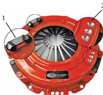
1. növelés: anyag felhegesztése 2. csökkentés: anyagelvétellel Tengelykapcsoló szerkezet kiegyensúlyozásának lehetőségei
